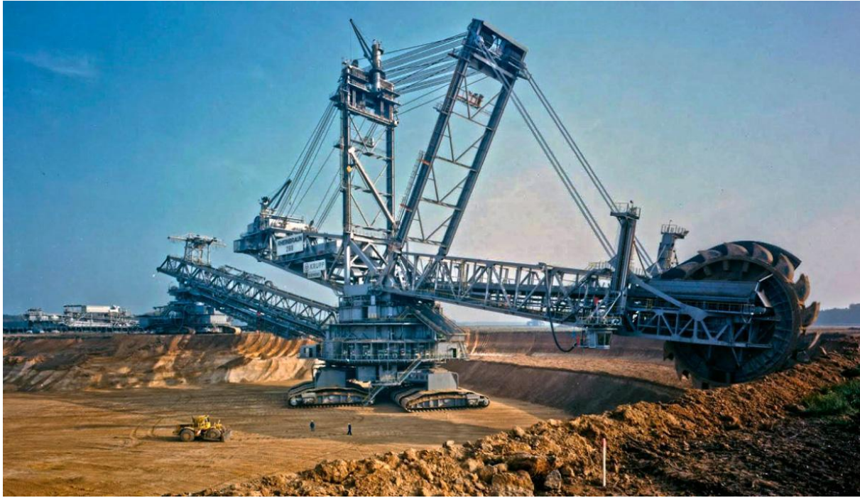
La Bagger 288 plus grosse excavatrice (240 000 t/j pour 16.5 MW)
